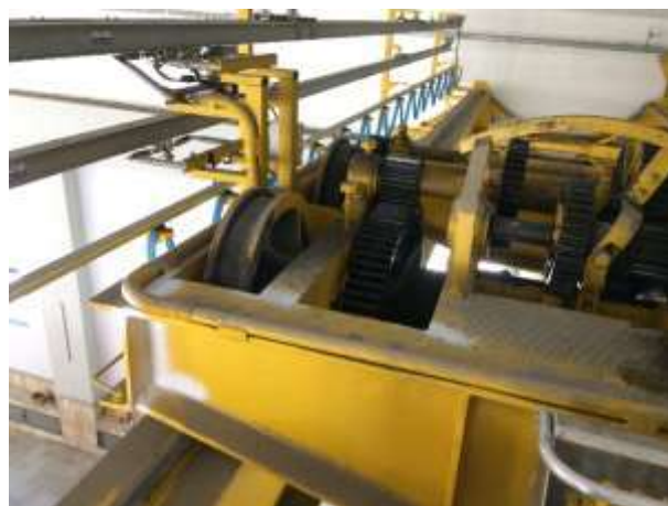
Controllo VT-MT struttura carrello
