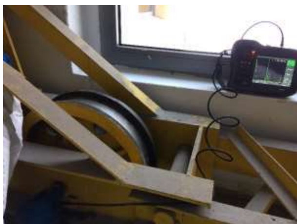
Controllo UT perno ruota lato indietro – interno
