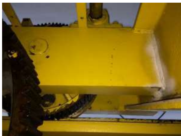
Controllo VT-MT struttura carrello
