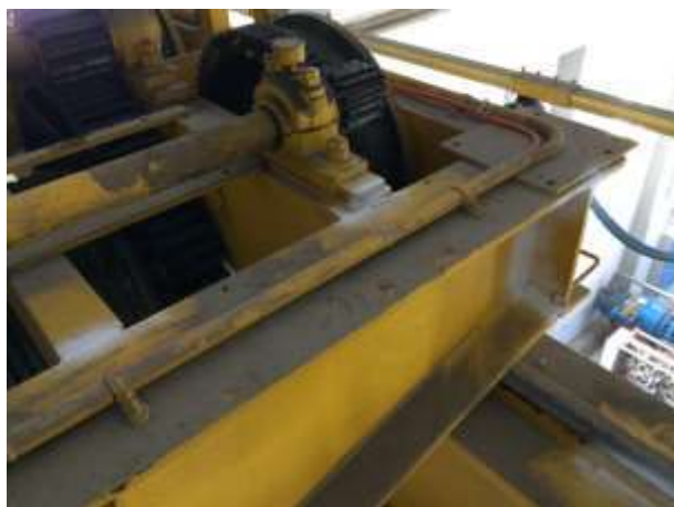
Controllo VT-MT struttura carrello
