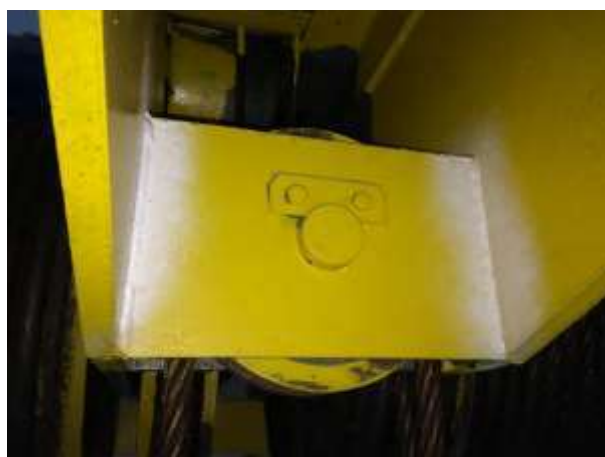
Controllo VT-MT struttura carrello: zona pulegge rinvio
