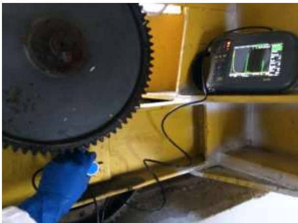
Controllo UT su perno ruota motrice lato indietro
