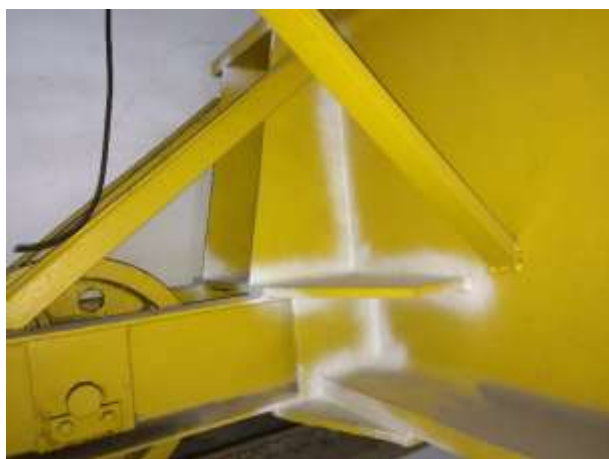
Controlli saldature lato avanti ponte - esterno
