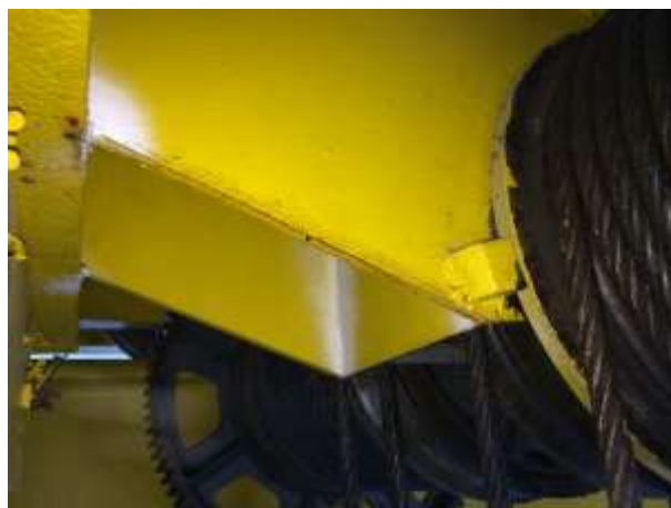
Controllo VT-MT struttura carrello
