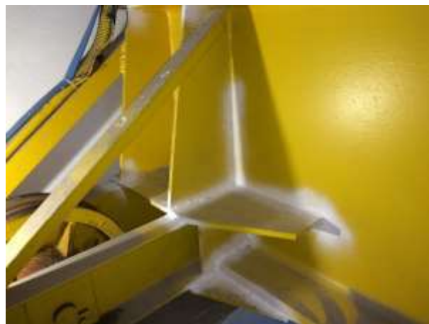
Controllo saldature lato indietro - interno
