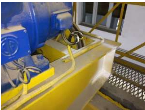
Controllo VT-MT struttura carrello
