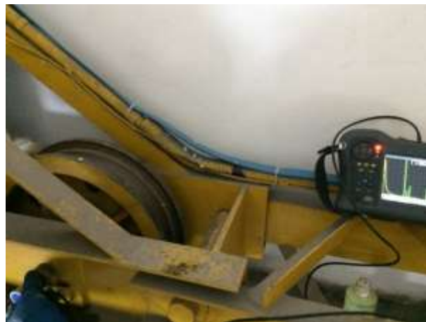
Controllo UT perno ruota folle lato avanti interno
