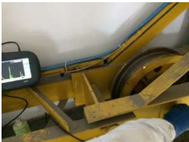
Controllo UT perno ruota folle lato indietro - interno
