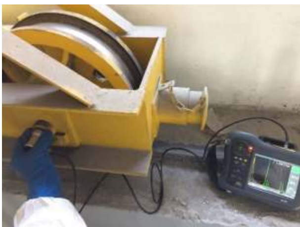
Controllo UT su perno ruota folle lato avanti - esterno
