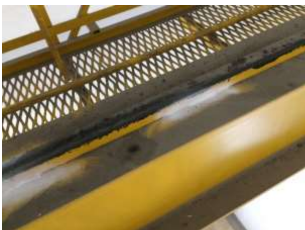
Controllo a campione saldature VDC del carrello
