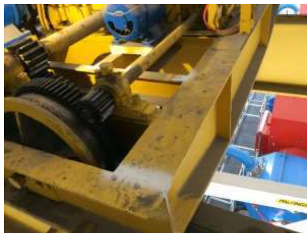
Controllo VT-MT struttura carrello
