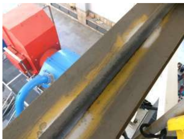
Controllo a campione saldature VDC del carrello
